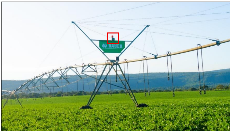
Figura 7 - Instalação do GPS CAN na última torre do pivô.
