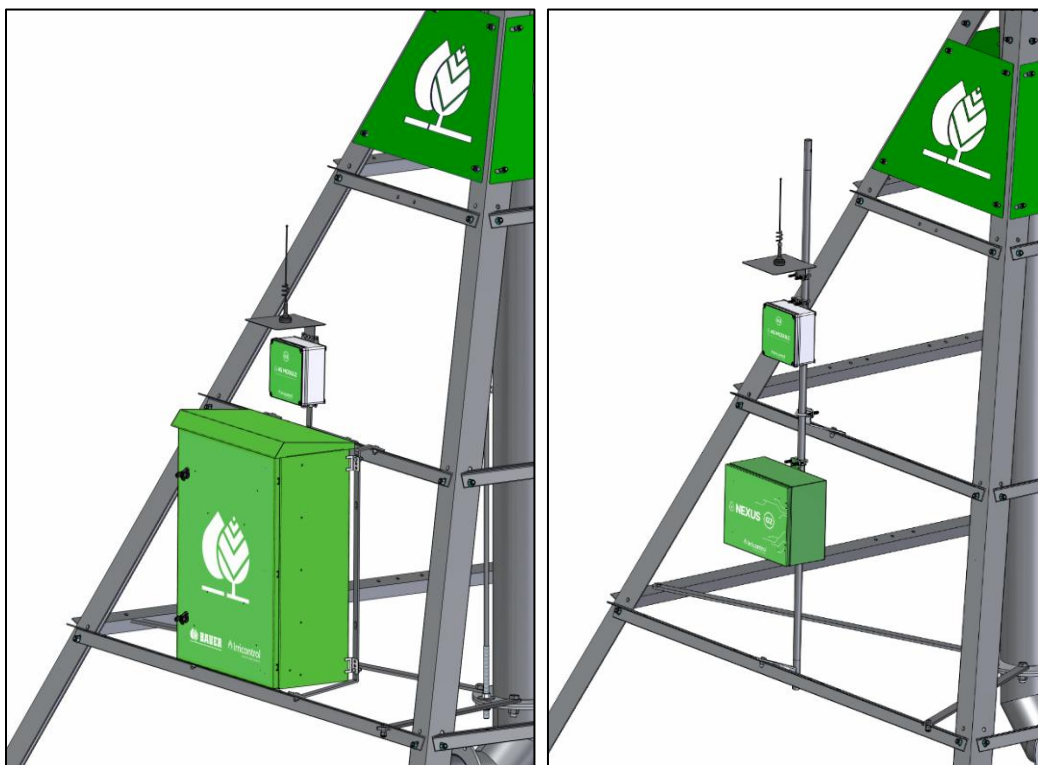
Figura 1 - Instalación del Módulo 4G G2 en la torre central - SmartConnect G2 y Nexus G2.
