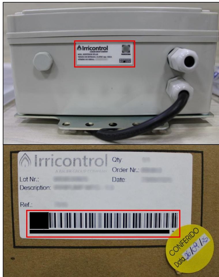
Figura 28 - Ubicación de las etiquetas con el número de serie del Repetidor Solar.
