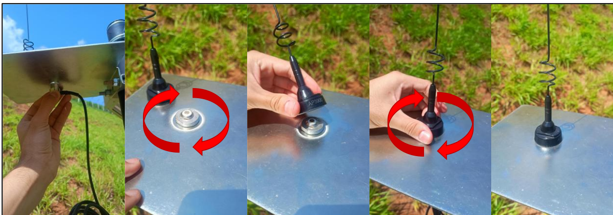
Figura 7 - Instalação da antena sobre o suporte.
