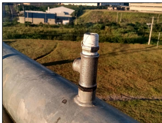
Figura 18 - Conexão do tee de redução e do nipple do sensor de pressão ao tubo do pivô.
