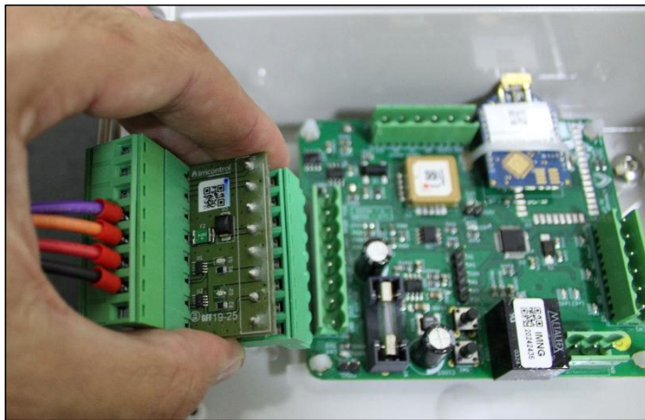
Figura 52 - Remoção do Shield da placa.
