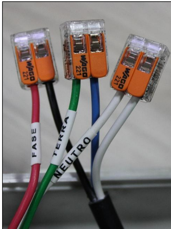
Figura 24 - Conexión de los hilos del cable de alimentación en el GPS.
