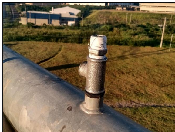
Figura 18 - Conexión del tee de reducción y del nipple del sensor de presión al tubo del pivote.
