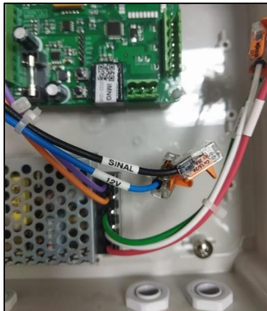
Figura 26 - Conexión del sensor de presión al GPS.
