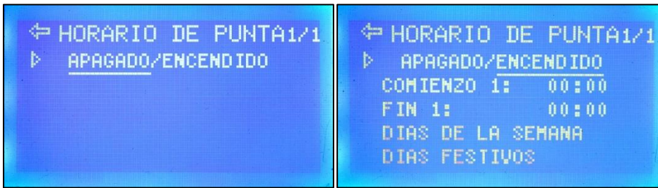
Figura 39 - Horario de Punta - Modos APAGADO y ENCENDIDO.
