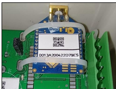
Figura 49 - Radio XBee utilizado en los productos Irricontrol.
