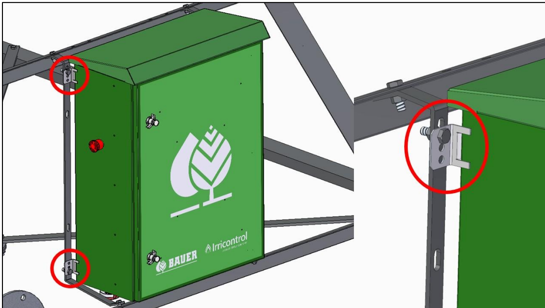
Figura 6 - Fijación del tablero a la torre central del pivote.
