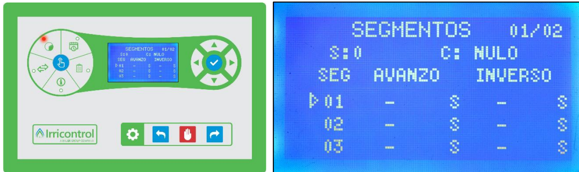
Figura 84 - Operación en Modo Riego por SEGMENTOS.
