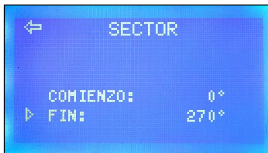
Figura 32 - Parámetro Sector para pivotes que operan por debajo de 360°.
