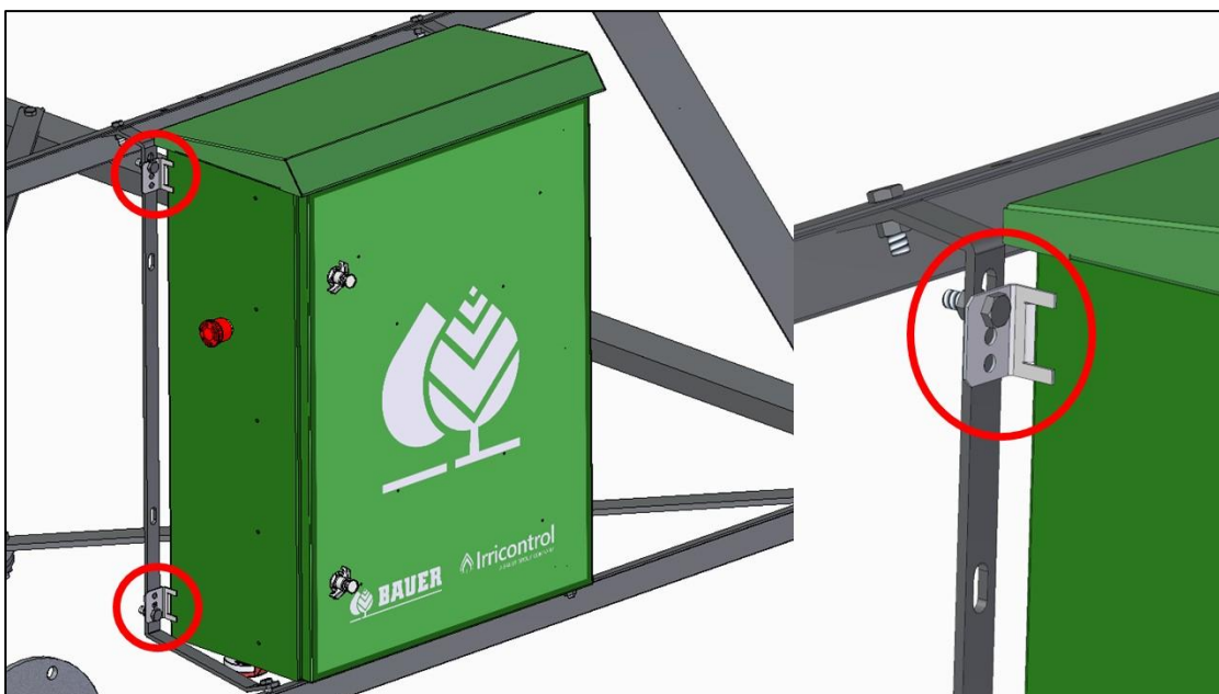
Figura 6 - Fixação do painel a torre central do pivô.
