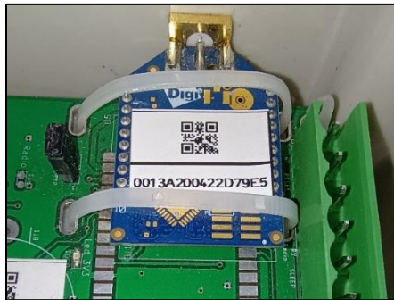
Figura 49 - Rádio XBee utilizado nos produtos Irricontrol.
