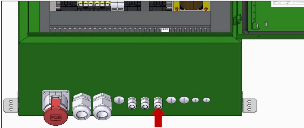
Figura 18 - PG para passagem dos cabos do SAF.
