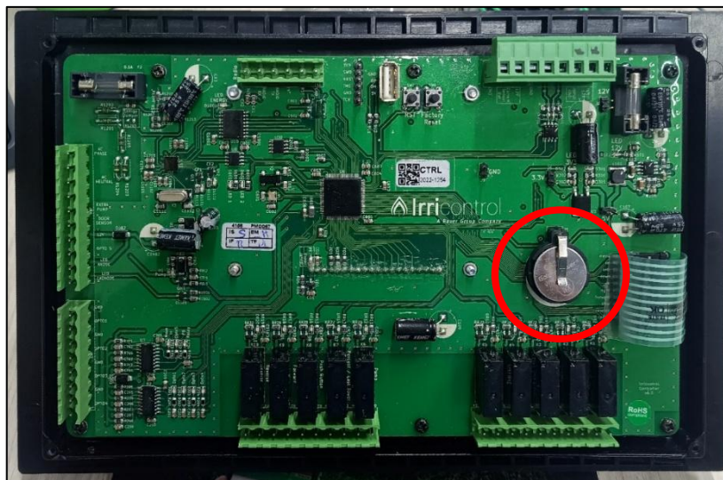
Figura 88 - Posição da bateria no controlador.
