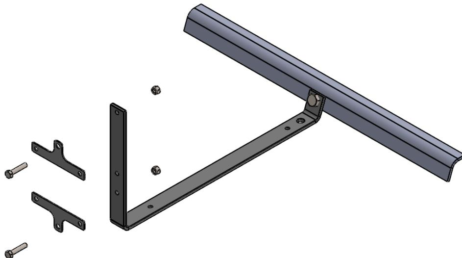
Figura 4: Encaixe do cabide menor no suporte inclinado
