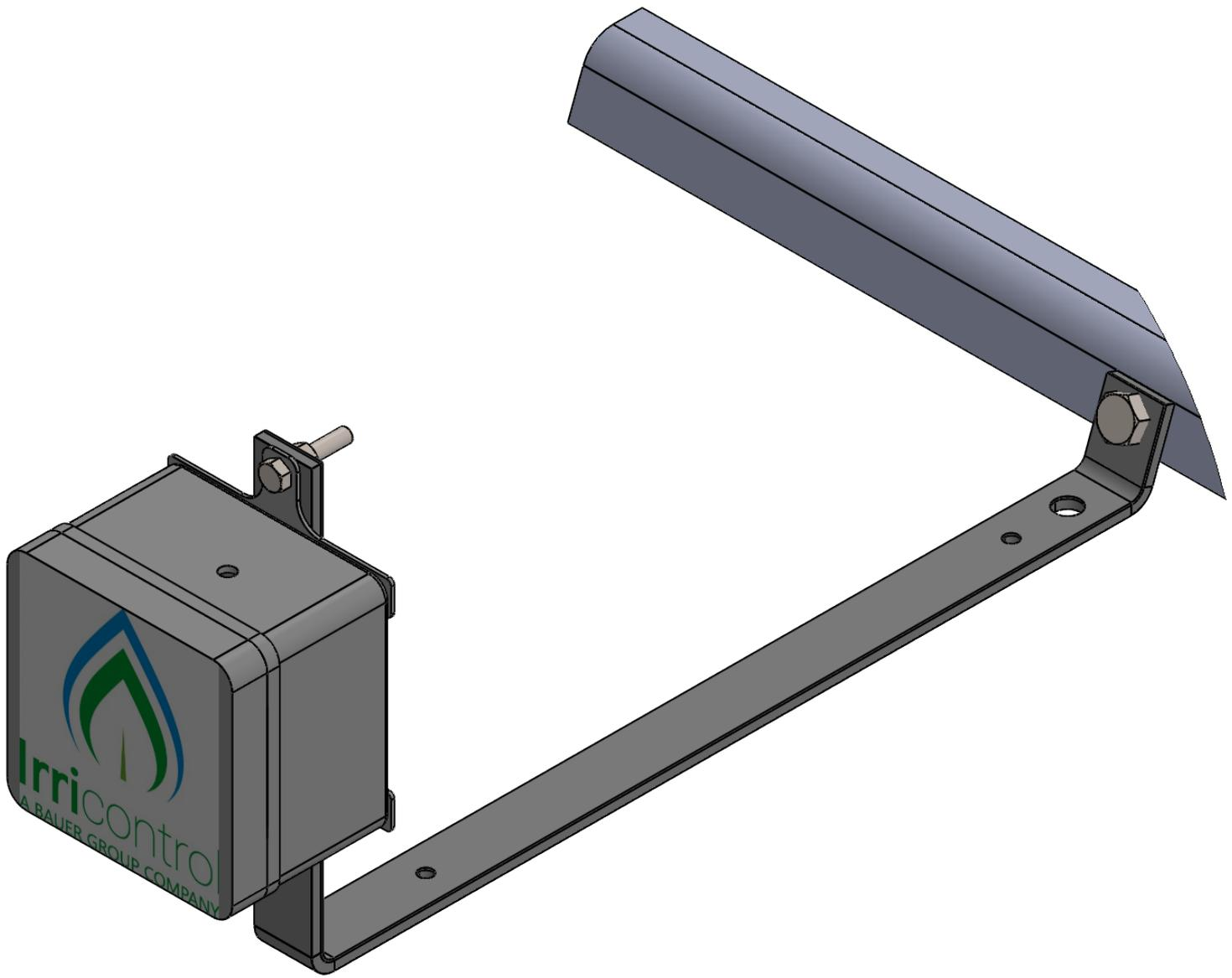
Figura 5: Montagem completa do suporte inclinado
